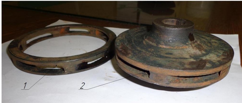
Рисунок 4.8 – Элементы конструкции: 1 – наружное рабочее колесо, 2 – внутреннее рабочее колесо.
