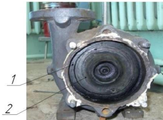
Рисунок 4.9 – Конструкция центробежного насоса с коаксиально установленными рабочими колесами: 1 – внешнее рабочее колесо, 2 – внутреннее рабочее колесо
